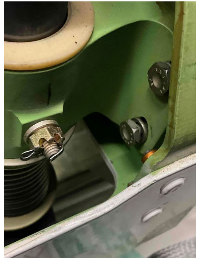
Ungesicherte und lockere Schrauben an einer Flugzeugtür
